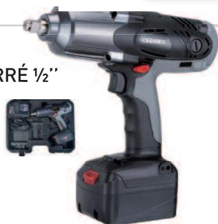
Couple efficace de 590 Nm réels modulable par gâchette progressive, carter bi-matières pour une résistance aux chocs inégale, nouveau moteur à refroidissement par ventilation, inverseur une main, poignée ergonomique.
