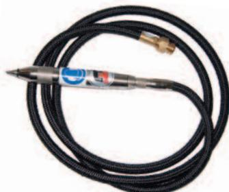
Livré dans son coffret en bois et équipé d'une pointe en carbure de tungstène, il possède une bague permettant de moduler sa fréquence. Utilisé pour les marquages de sécurité, antivols, les tachygraphes, les flexibles hydrauliques, les repérages. Traçabilité des outils et des composants. Fonctionne sur pratiquement toutes les matières.
